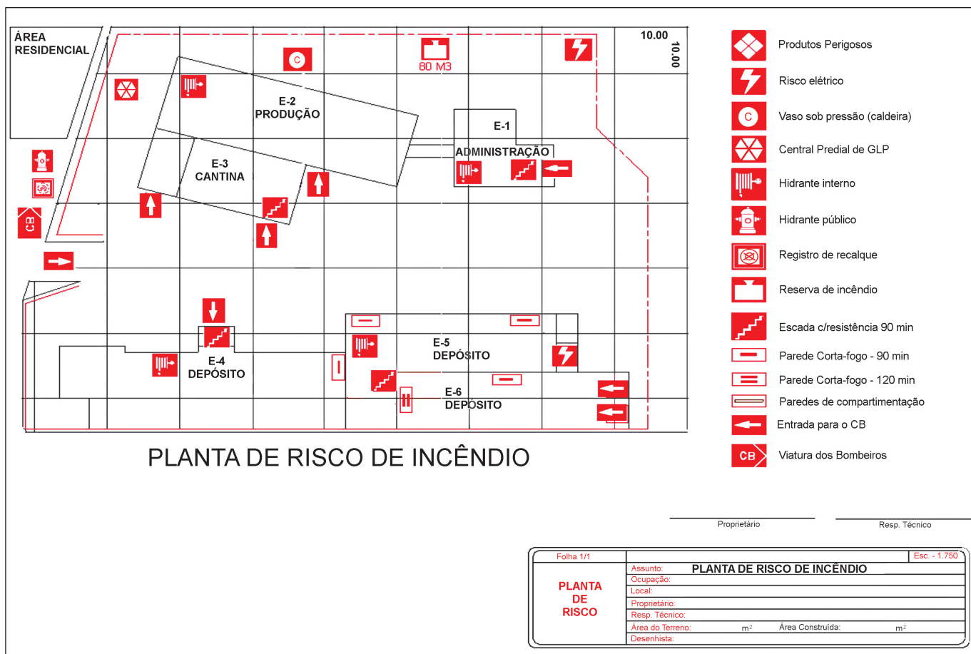
Figura 75: Planta de risco. Fonte: IT 01/11.
