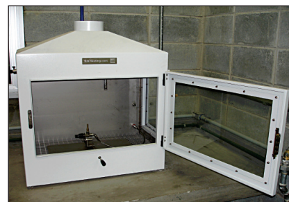
Figura 44: Determinação da ignitabilidade dos materiais
